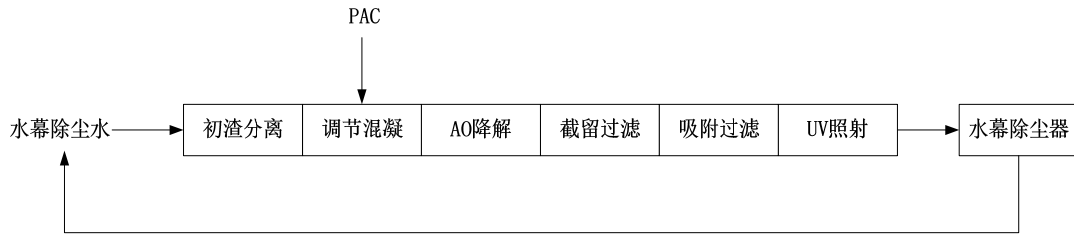
图 3-1：水帘除漆雾水处理流程图
